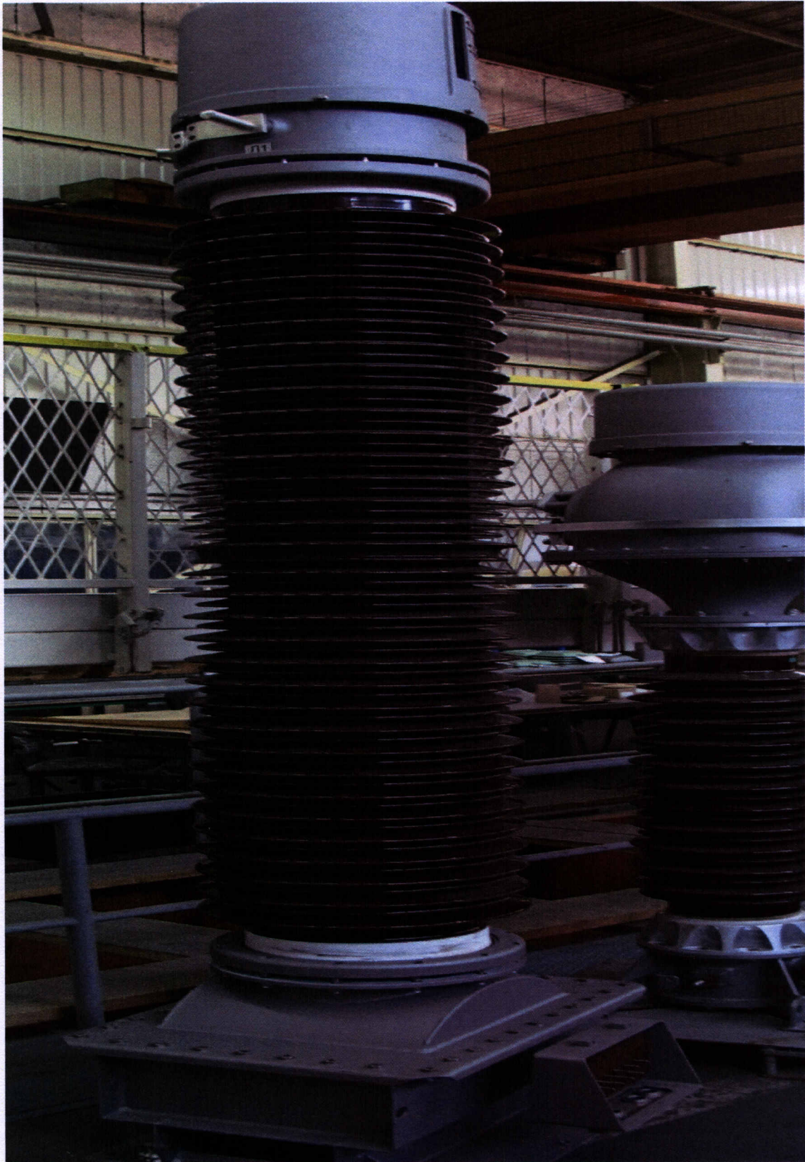
Slika 2. Fotografija strujnog mjernog transformatora tipa APU-245
